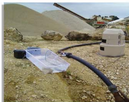
Mise en place de préleveurs automatiques permettant la récupération d'échantillons d'eau à pas de temps réguliers
