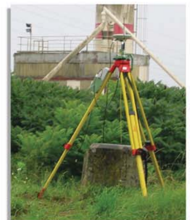
Nivellements des repères de mesures avec un GPS différentiel
