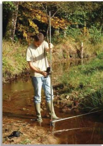
Jaugeages en rivière avec un courantomètre acoustique de la marque OTT
